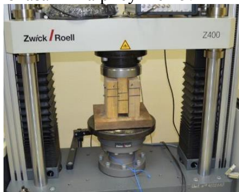
Рисунок 14 — Образец в испытательной машине Zwick Z400E
