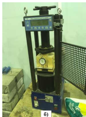
Рисунок 11 — Расчетная схема и образец в прессе ПГМ-500МГ
