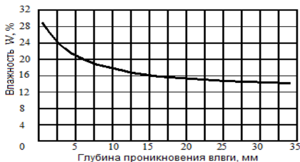
Рисунок 4 — Распределение влаги по глубине сечения
